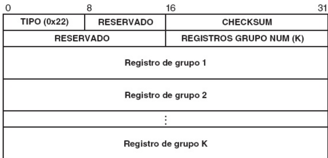
Figura 15.10 O formato de uma mensagem membership report IGMPv3.
