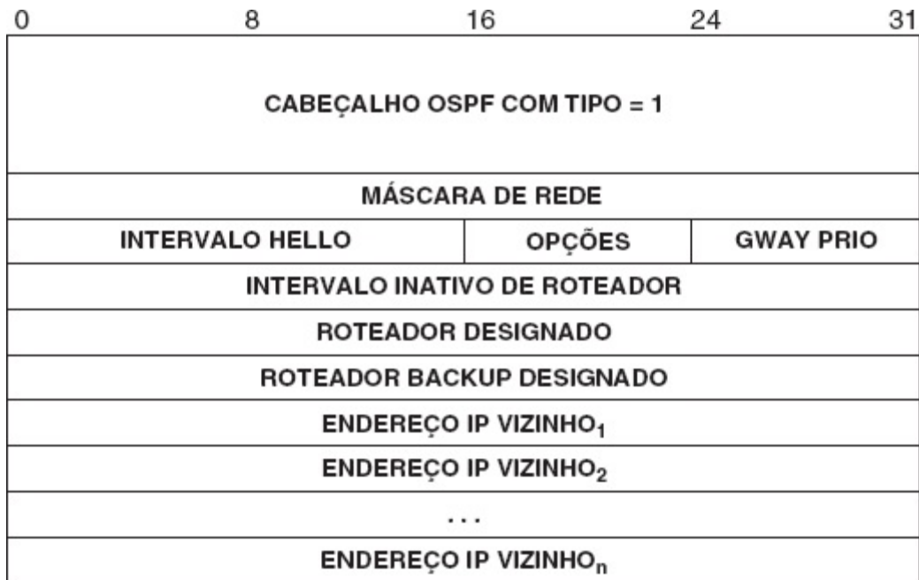
Figura 14.10 Formato de mensagem HELLO OSPFv2. Um par de roteadores vizinhos troca mensagens periodicamente para testar a alcançabilidade.
