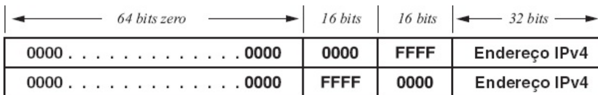
Figura 5.12 Duas formas de incorporar um endereço IPv4 em um endereço IPv6. A segunda forma é usada para tradução Stateless IP/ICMP.
