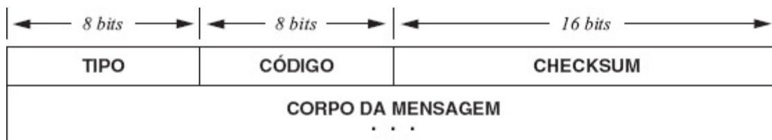
Figura 9.2 Os três primeiros campos em cada mensagem ICMP.
