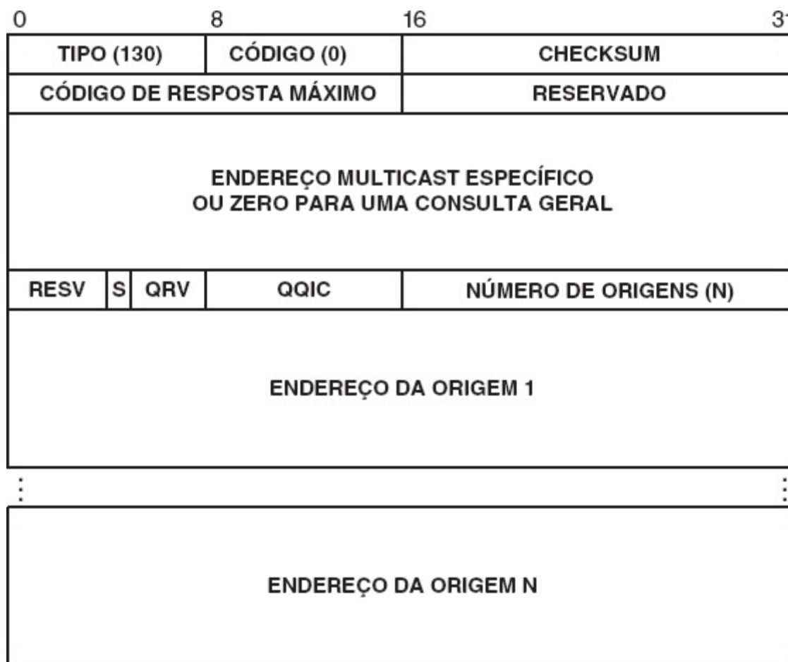
Figura 15.12 Formato de uma mensagem consulta MLDv2. Um roteador
