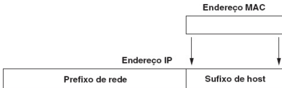
Figura 6.1 Uma ilustração do esquema de um mapeamento direto no qual um endereço de hardware de um computador é inserido em seu endereço IP.
